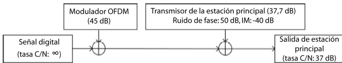
Figura 28 — Ejemplo de distribución de la tasa equivalente de C/N para la estación principal cuando el sistema de transmisión TS se usa para STL
