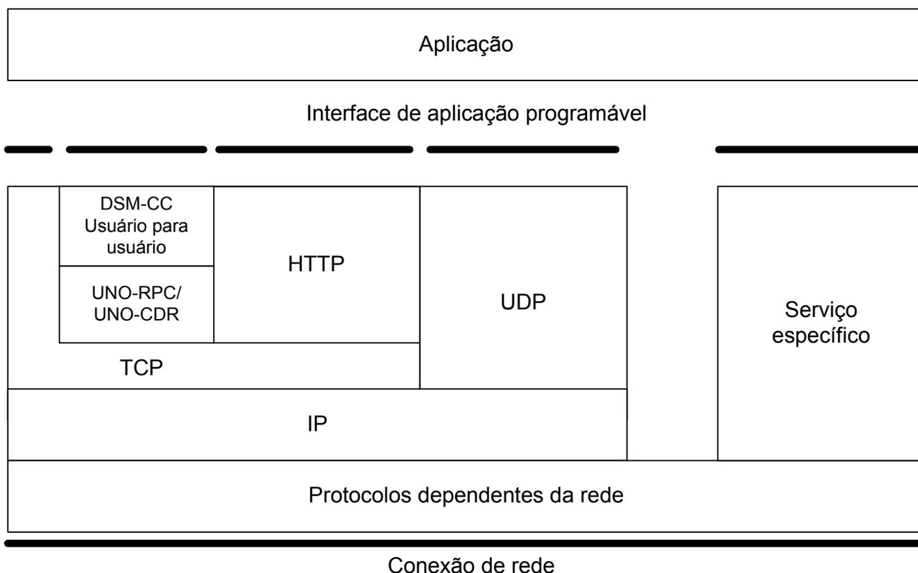
Figura 4 — Pilha de protocolo do canal de interação
